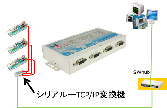
図5：シリアル TCP/IP 変換機を使ったネットワーク
